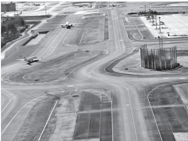
用地が確保できないまま工事を強行したため、大きく「へ」の字に曲がった成田空港の誘導路。専門家はその危険性を指摘。利益優先・安全軽視のN A Aの姿勢があらわだ。
